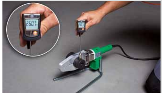
Temperaturmessung am aquatherm- Handschweißgerät (800 W)
