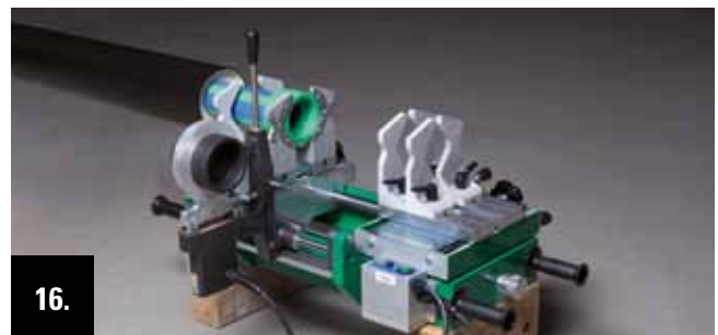
Nach Ablauf der Abkühlzeit Spannbacken an Formteil und Rohrende lösen und Schweißmaschine um 180° wenden.
