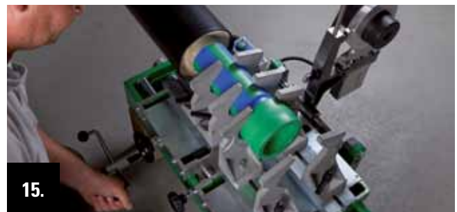
Schlitten der Schweißmaschine mit der Drehkurbel bis zum Anschlag zusammenfahren.
