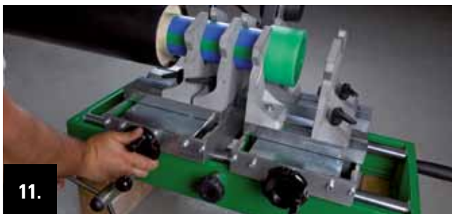
Rohrende mit Spannbacken durch Drehen des Kurbelgriffs fest einspannen.
