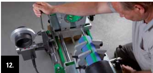
Schlitten der Schweißmaschine mit der Drehkurbel auseinanderfahren und den Kalibrierungsknopf zur Voreinstellung der Einschweißtiefe herausziehen.
