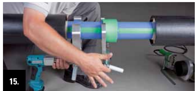
15. Spannbacken auf der Formteilseite durch Losdrehen der Befestigungsschraube lösen.
