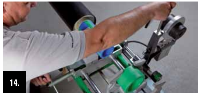
Nach Ablauf der Anwärmzeit Schlitten der Schweißmaschine mit der Drehkurbel auseinanderfahren und Schweißgerät hochklappen.
