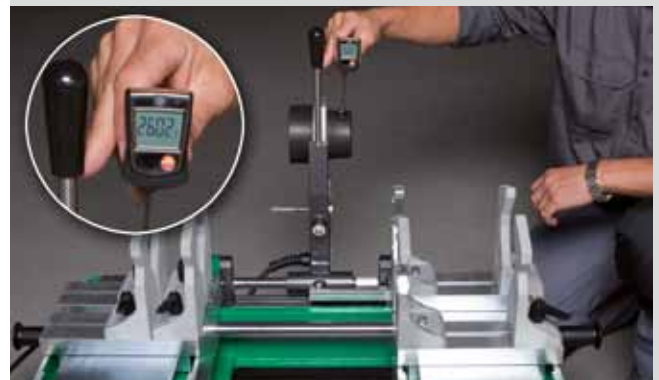
Temperaturmessung an aquatherm- Schweißmaschine
