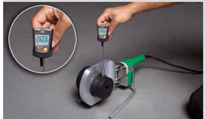
Temperaturmessung am aquatherm- Handschweißgerät (1400 W)
