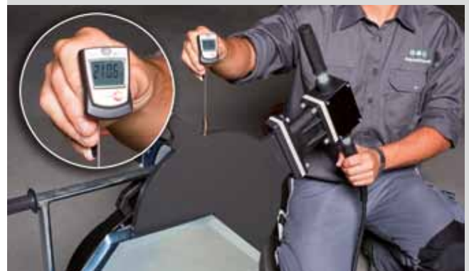
Temperaturmessung an aquatherm- Stumpfschweißmaschine
