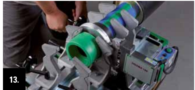
Schweißgerät herunterklappen und Schlitten der Schweißmaschine mit Drehkurbel zusammenfahren.
