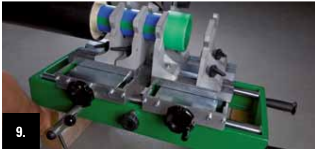
Schlitten der Schweißmaschine mit der Drehkurbel zusammenfahren und das Rohrende an die Schweißmuffe drücken.
