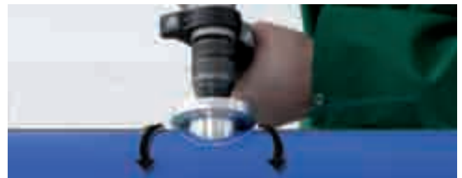
Entfernen der Sauerstoffsperrschicht beim climatherm OT Rohr
