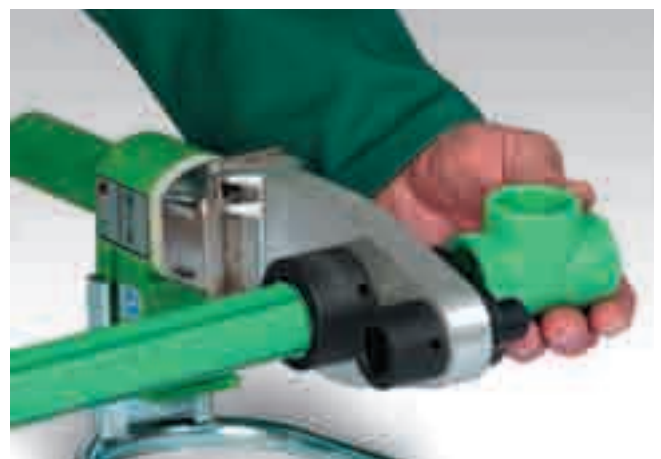
Anwärmen der Formteile
