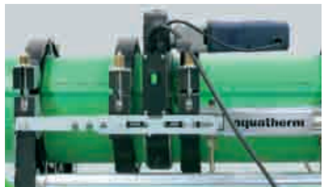
Schweißteile einspannen, ausrichten, fixieren Fräßeinrichtung einsetzen
