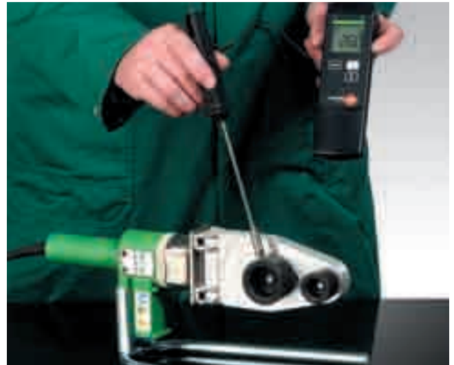
Temperaturkontrolle mit Oberflächenmessgerät
