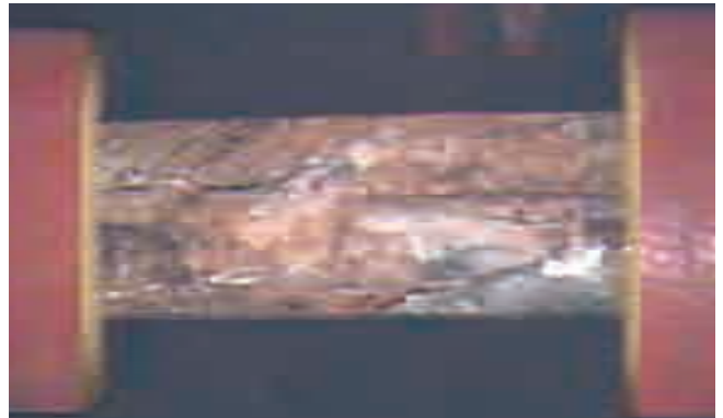
Unter der Isolierung korrodiertes Metallrohr
