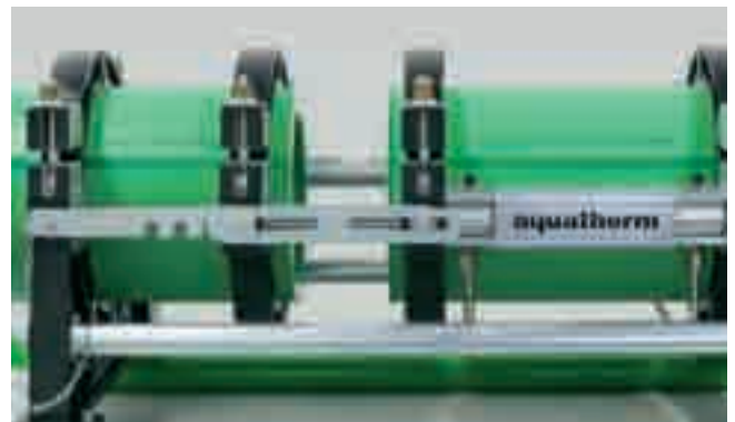
Rohre auseinanderfahren, Heizelement entnehmen
